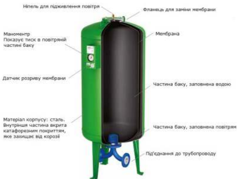
Рис. 59 Будова розширювального бака
