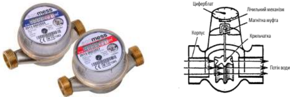
Рис. 23 - Лічильники холодної та гарячої води з різьбовим з'єднанням
