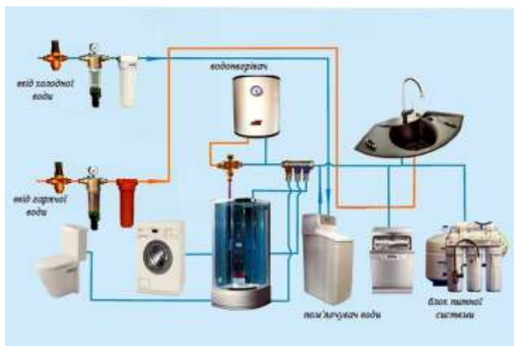
Рис. 49 Схема очищення води в квартирі
