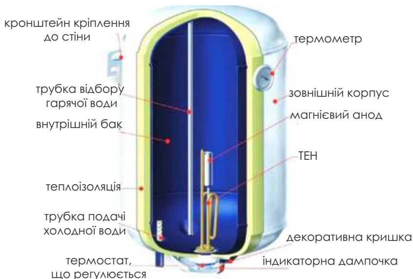
Рис. 102 Будова накопичувального водонагрівача
