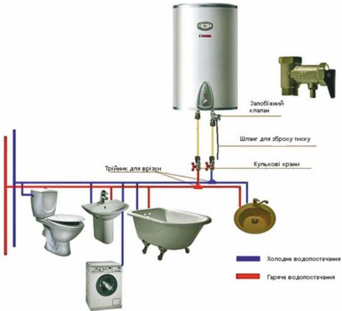
Рис. 92 Схеми підключення гарячої та холодної води в квартирі
