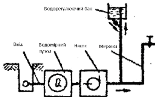
Рис. 17 Схема з водорегулюючими баками и насосом
